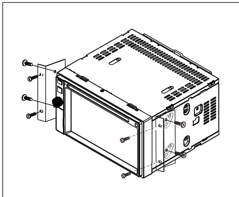
**VORSICHT: Verwenden Sie keine Schrauben, die größer als M5x6 mm sind. Durch längere Schrauben werden unter Umständen Komponenten im Inneren des Gehäuses berührt und beschädigt.**
